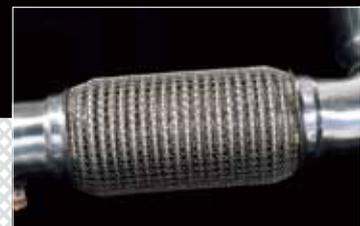
キャタライザーと一体型のダウンパイプ。純正品とそっくり取り換えるカタチで装着する。純正品と
