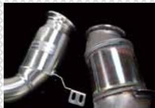
右側が純正触媒で、左側がメタルキャタライザー。排気ガスが通過する空間の広さが明らかに違っている。
